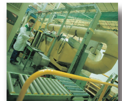
HEPA фильтры проходят индивидуальные испытания согласно EN1822
