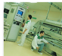
HEPA фильтры проходят индивидуальные испытания согласно EN1822
